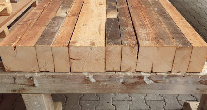
Deckenelement einer Re-Use Holzdecke aus einzelnen Balkenquerschnitten (Pirmin Jung Schweiz AG)
