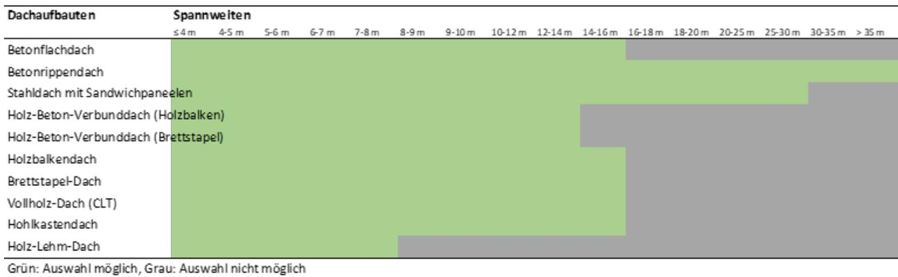
Abbildung 48: Mögliche Kombinationen der gewählten Dächern und Spannweiten
