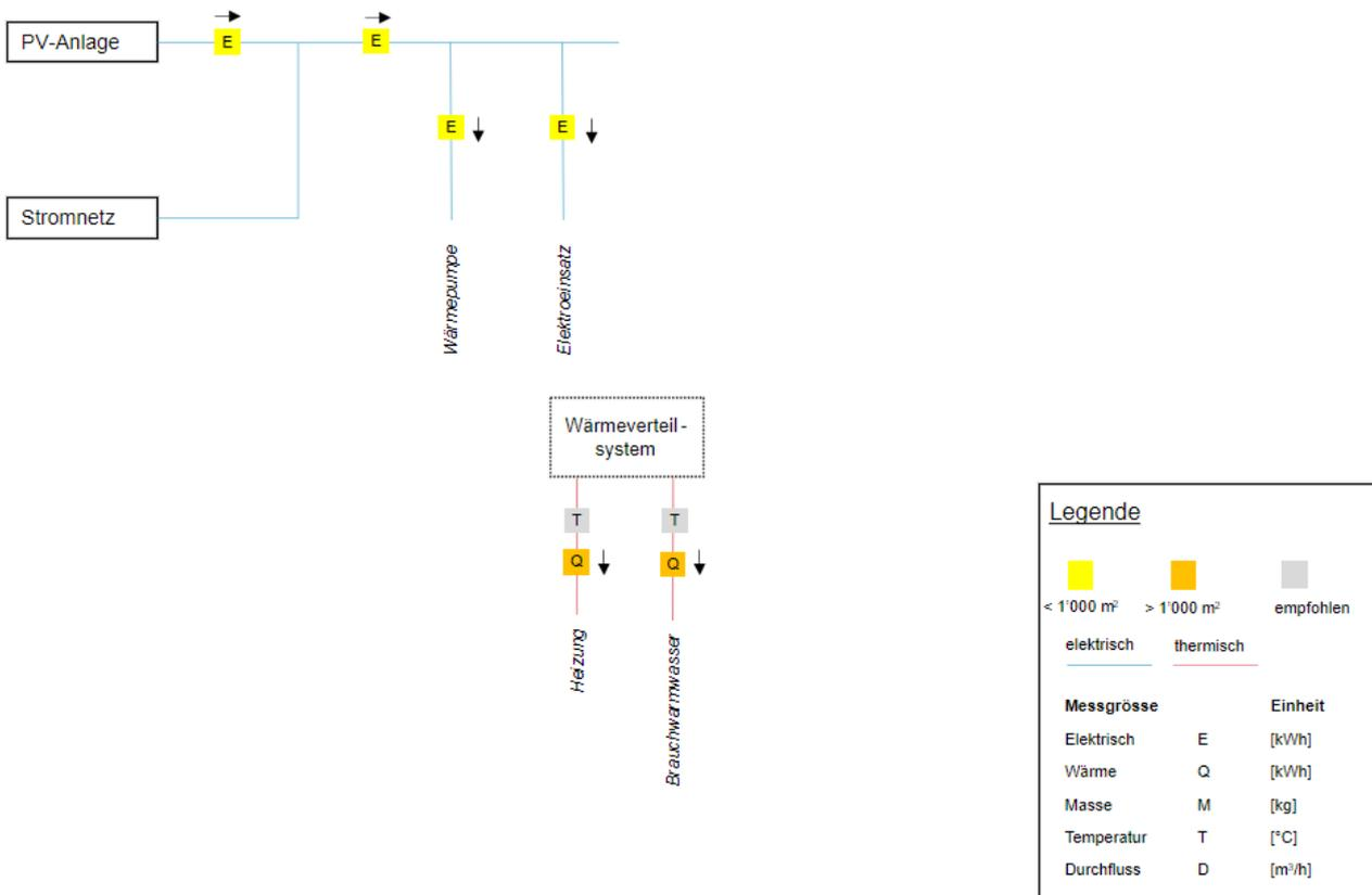
Abbildung 45: Datenpunkte Minergie Monitoring am Beispiel MFH mit Wärmepumpe und Elektroeinsatz
