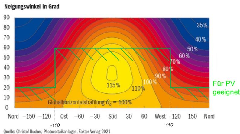
Abbildung 39: Als nutzbare Dachfläche einzurechnende Dachfläche nach Ausrichtung. Die innerhalb der grün schraffierten Fläche liegenden Teildachflächen gelten als PV-geeignet. Dies sind alle weniger als 20° geneigten Flächen sowie alle weniger als 60° geneigten Fläche, die zwischen WNW (110°) und ONO (-110°) liegen.
