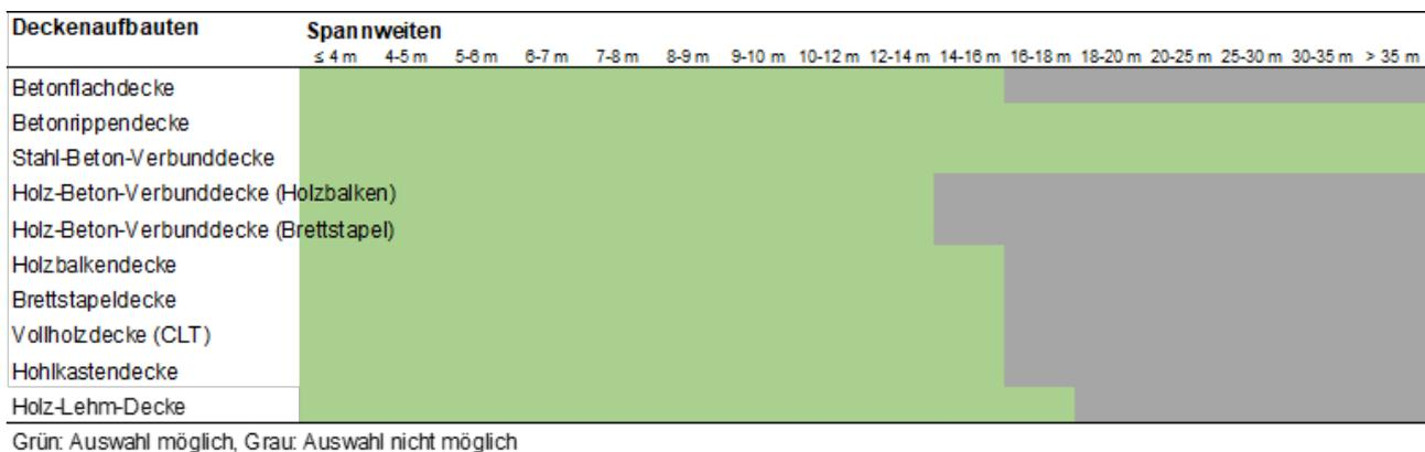
Abbildung 49: Mögliche Kombinationen der gewählten Decken und Spannweiten
