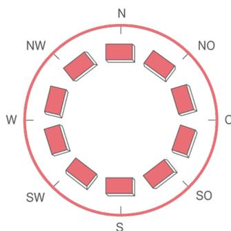
Abbildung 40: Bei Dachneigungen unter 20° gilt jeweils das ganze Dach als nutzbare Dachfläche und ist für den Nachweis komplett einzurechnen. Die einzurechnenden Flächen sind rot gekennzeichnet.
