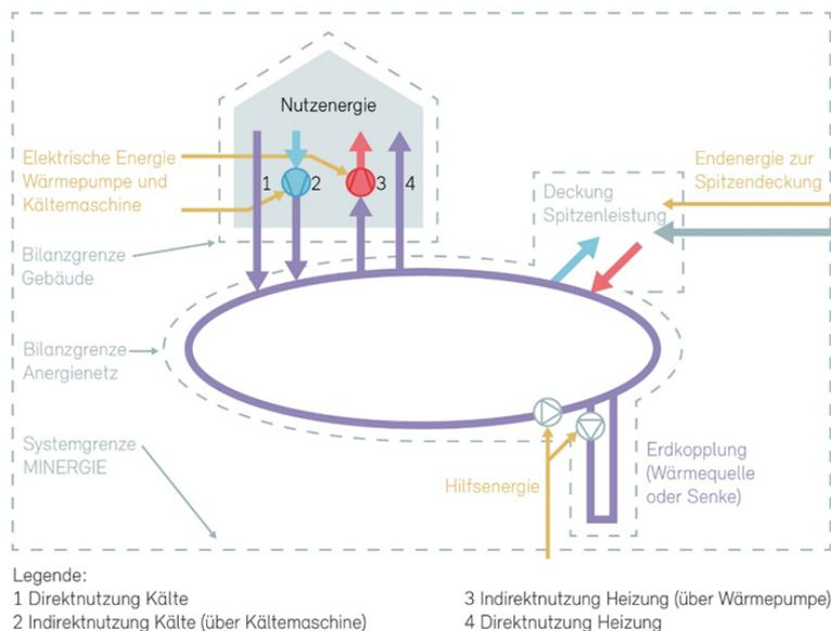
Abbildung 27: Prinzipskizze Anergienetz
