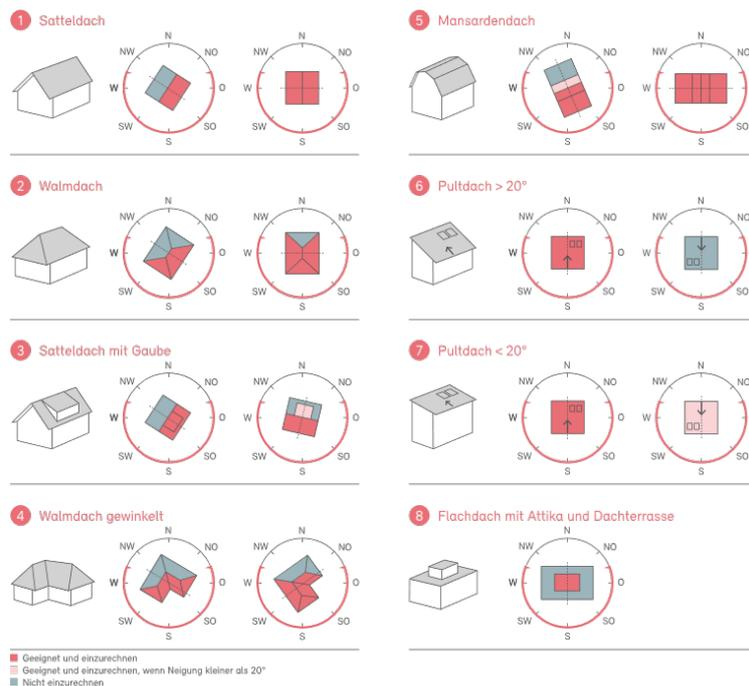
Abbildung 42: Einrechnung der nutzbaren Dachfläche anhand eigener Beispieldächer
