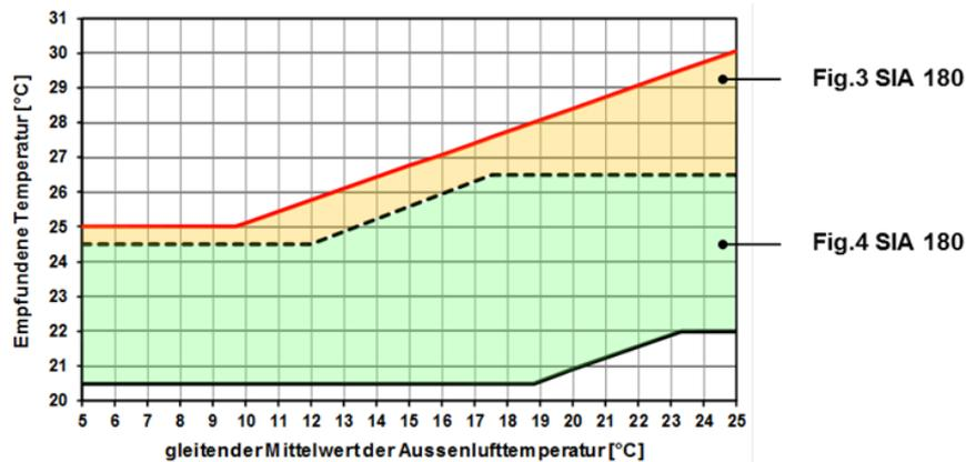
Abbildung 16: Fig.3 und Fig.4 nach SIA 180
