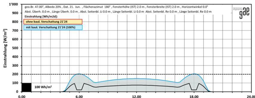
Abbildung 20: Einstrahlungsdiagramm Nord (21. Juni)
