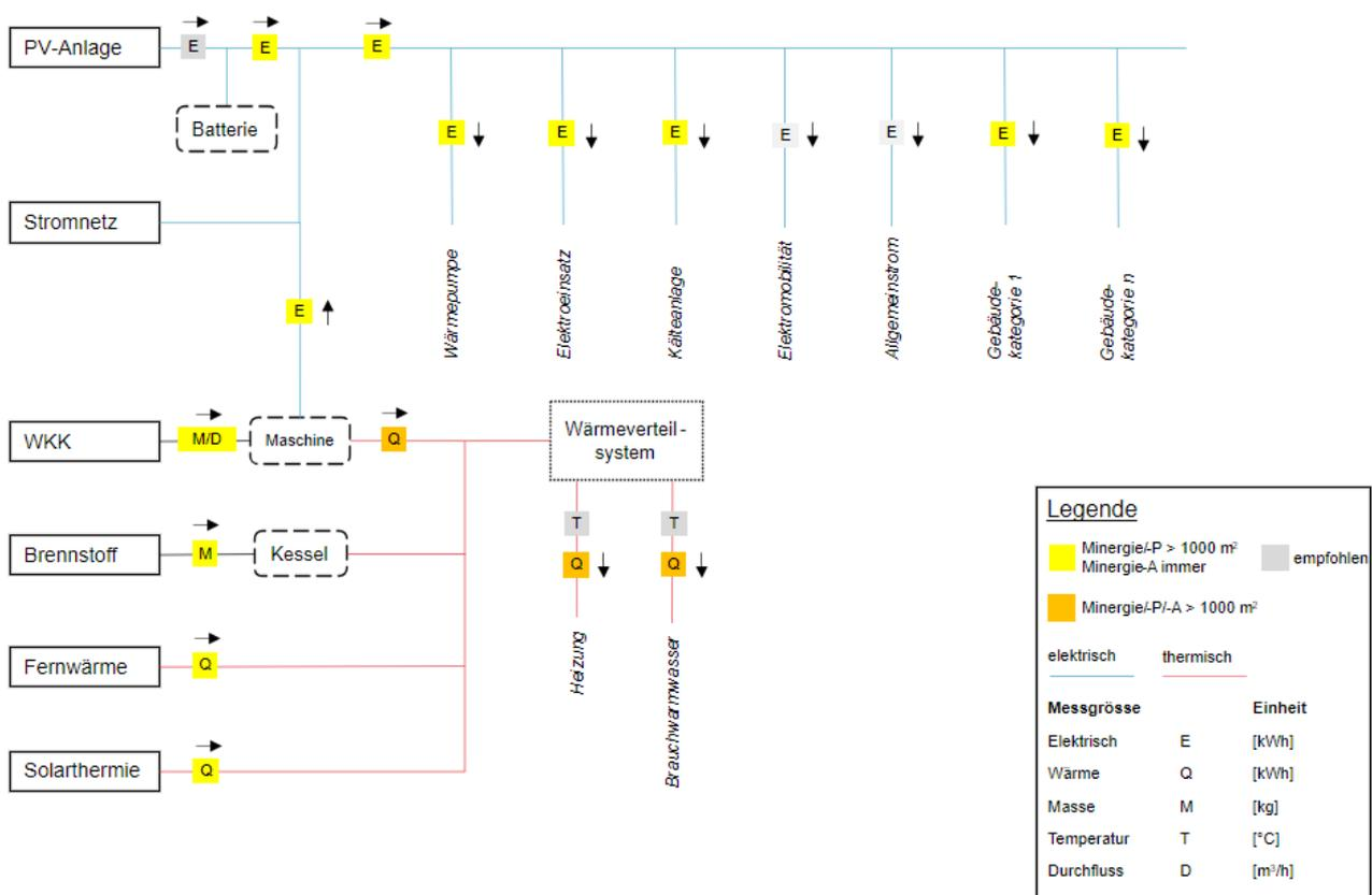
Abbildung 44: Messpunkte / Datenpunkte Minergie Monitoring
